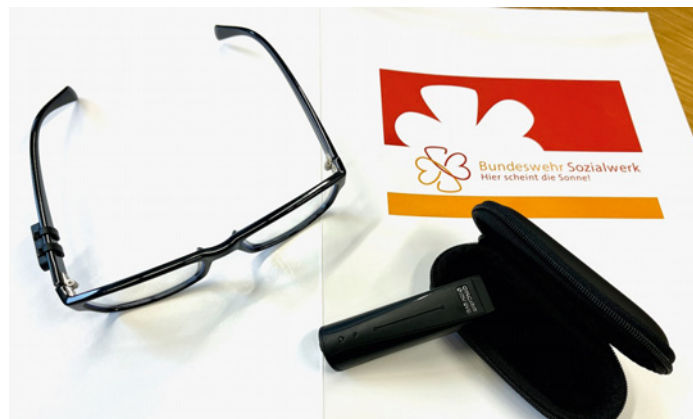
OrCam MyEye: Links im Bild die Brille mit Kamerahalterung. Rechts die 22,5 g leichte und 76 mm lange Kamera mit Etui.
